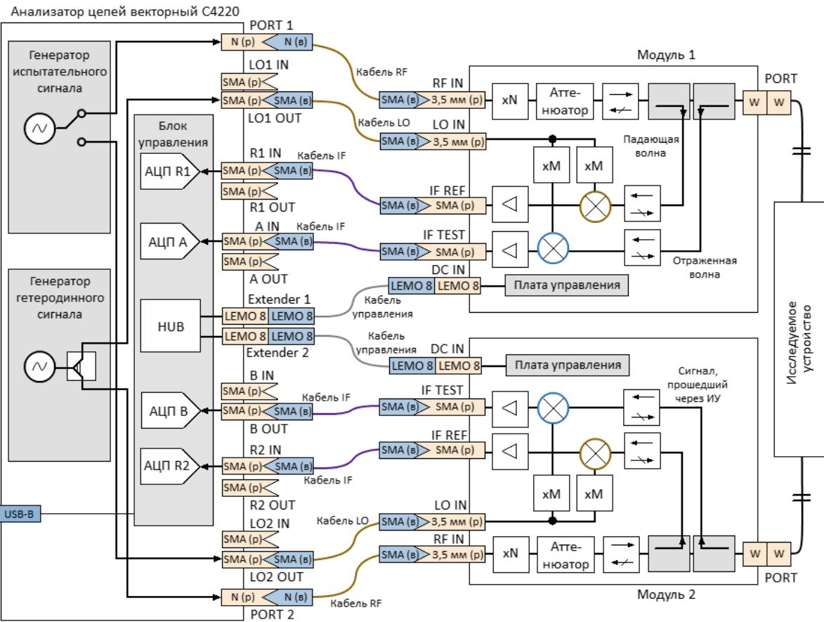
Рисунок 3 – Схема подключения модулей к анализатору для измерения двухпортового ИУ
