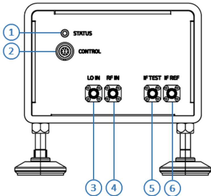
Рисунок 5 – Задняя панель
