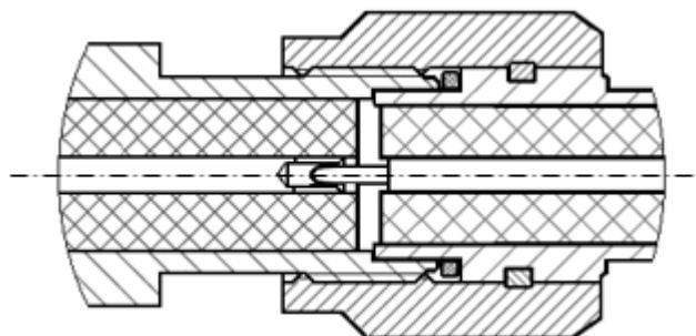
Рисунок 8 – Соединители тип SMA (розетка слева, вилка справа)
