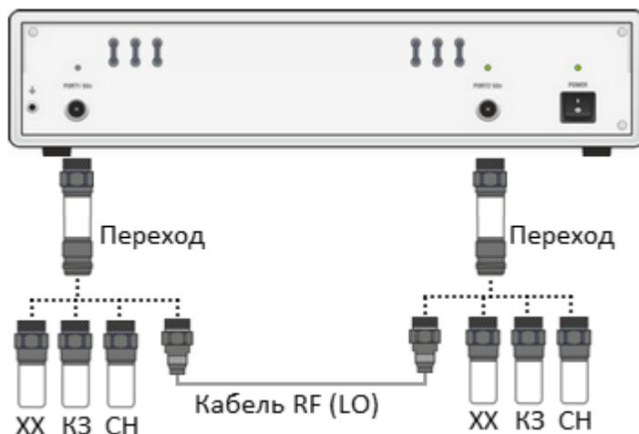
4. После калибровки анализатора подключите кабель RF (LO) и измерьте его модуль коэффициента передачи  $S21(f)$  в дБ. Измерения и дальнейшие вычисления следует выполнять отдельно для каждого кабеля RF(LO).
