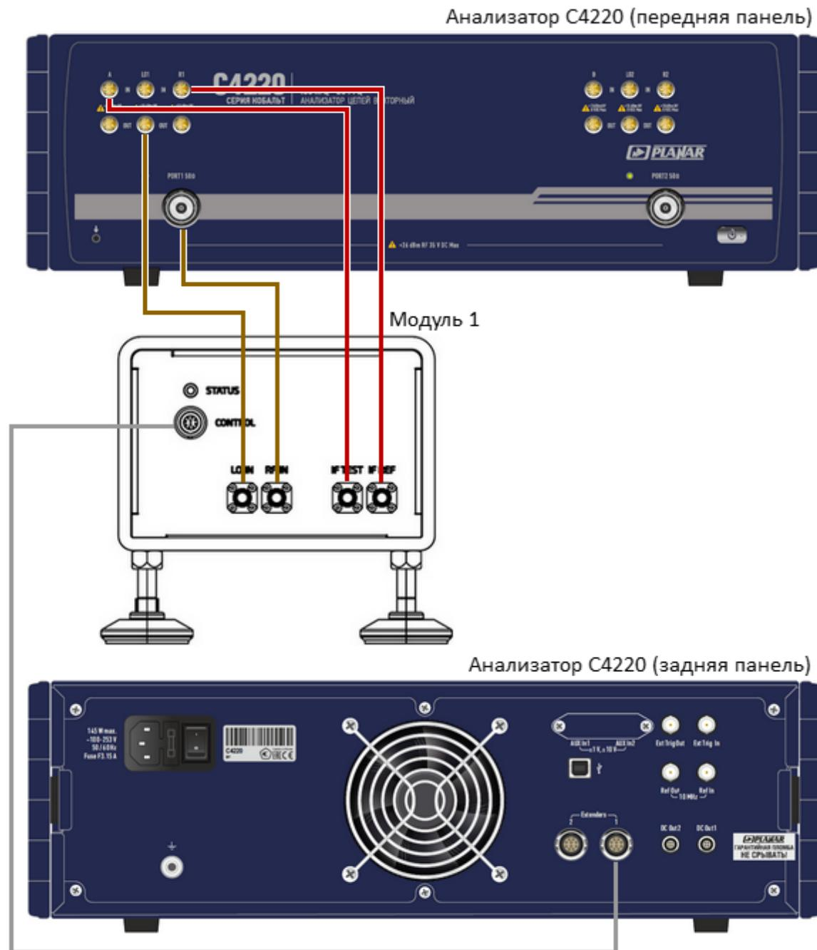
Рисунок 6 – Подключение модуля к анализатору цепей векторному C4220
