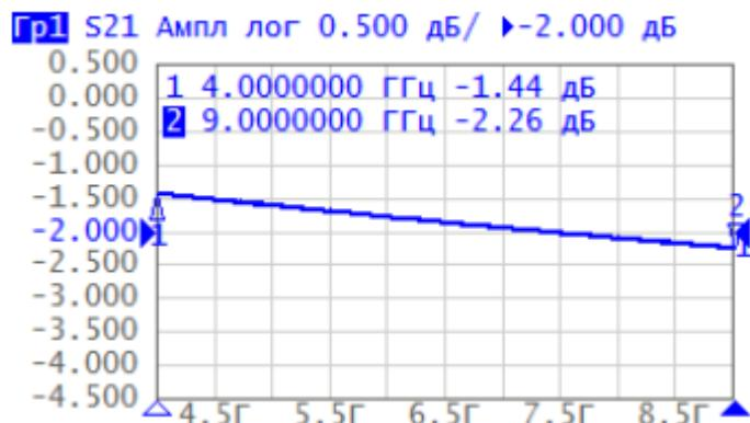
В приведенном примере  $S21(f_{\text{H}} = 4 \text{ ГГц}) = -1,44 \text{ дБ}$ ,  $S21(f_{\text{B}} = 9 \text{ ГГц}) = -2,26 \text{ дБ}$ .
