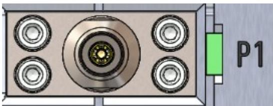
Радиочастотные соединители P1, P2, P3, P4 предназначены для коммутации для каналов 1, 2, 3, 4. Тип соединителей 2,92 мм, розетка.
